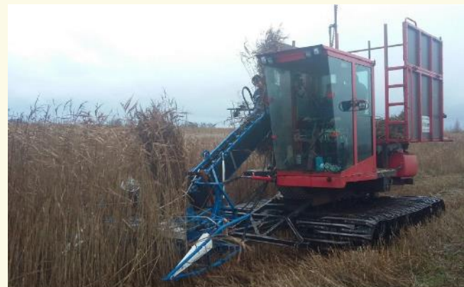
Abb. 3: Winterliche Schilfmahd in Bündeln mit raupenbasierter Technik. Foto: F. Birr, 12/2018.
