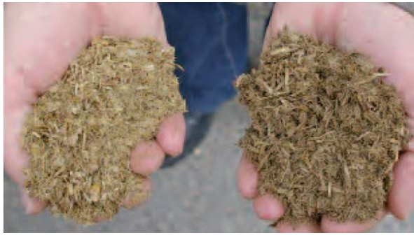
Abb.41: Vergleich von Natur und Technik, links im Bild sind die getrockneten Exkremente einer Kuh zu sehen, während rechts die Gärreste aus einer Biogasanlage, die nach dem Rottaler Modell betrieben wird, zu sehen sind (QUELLE: ENERGIE PFLANZEN II/2008).
